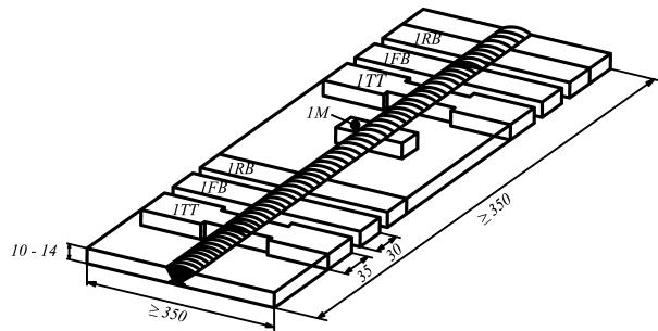
Рис. 4.10.3.1-1 Проба стыкового соединения для сварки в различных пространственных положениях:
