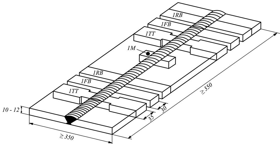
Рис. 4.9.3.1-1 Проба стыкового соединения для сварки в различных пространственных положениях:
