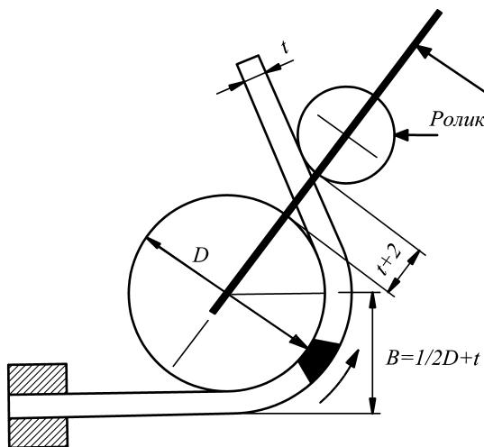
Рис. 4.9.3.6 Схема проведения испытаний на статический изгиб по методике, предусматривающей обрачивание образца вокруг оправки
