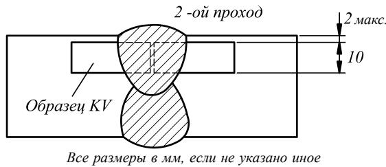
Рис. 4.4.3.2.3 Схема вырезки образцов на ударный изгиб
