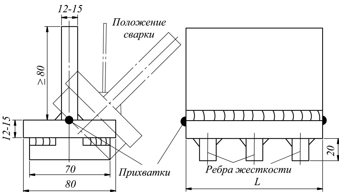
Рис. 4.2.4.1 Тавровая пробы для оценки стойкости сварных соединений к образованию горячих трещин:
