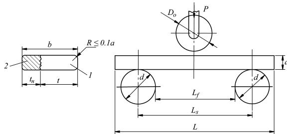
Рис. 4.8.4.2 Образец с плакирующей наплавкой
