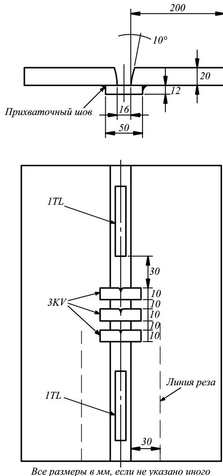
Рис. 4.4.2.2.1 Проба наплавленного металла при испытаниях сочетания «проводка — флюс»
