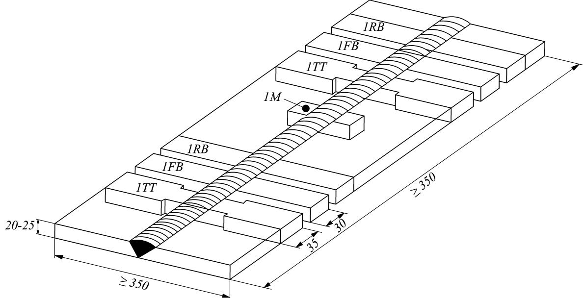
Рис. 4.9.3.1-2 Дополнительная проба стыкового соединения для сварки в нижнем пространственном положении:
