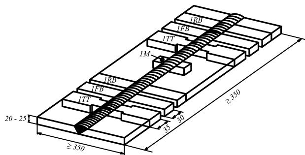
Рис. 4.10.3.1-2 Дополнительная проба стыкового соединения для сварки в нижнем пространственном положении:
