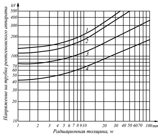
Рис. 3.2.4.5 Максимальные значения напряжения на трубке рентгеновского аппарата зависят от радиационной толщины контролируемого металла:
