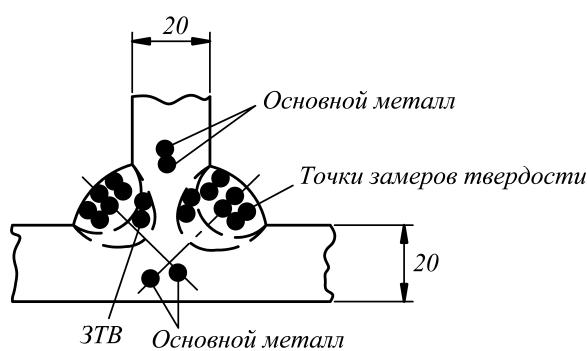
Рис. 4.3.6.3 Схема замеров твердости на макрошлифе из пробы таврового соединения
