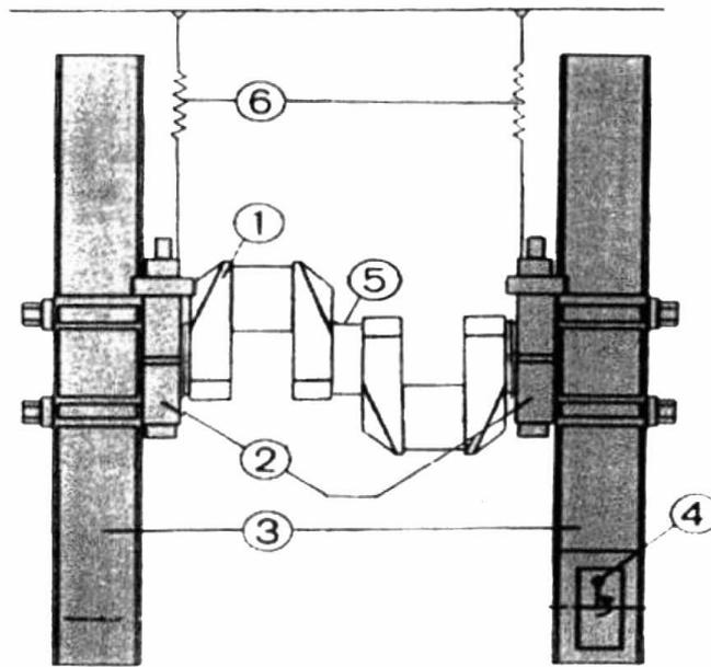
Рис. 4.2-2. Пример устройства резонансного стенда для испытания двухсекционного кривошипа крутильной нагрузкой
