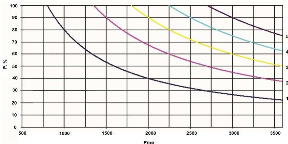
Рис. 2.11.3.2 Предельные допустимые величины мгновенного наброса ступенчатой нагрузки четырехтактного двигателя от холостого хода до заявленной мощности в функции от среднего эффективного давления:
