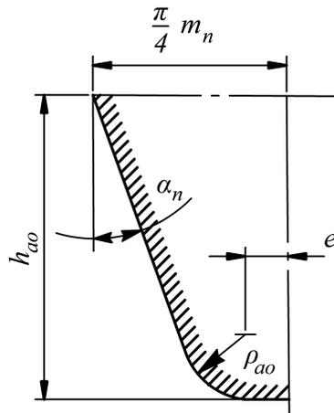
Рис. 4.2.2.7.3.2-2 Исходный производящий контур фрезы без протуберанца
