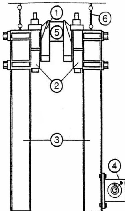
Рис. 4.2-1. Пример устройства резонансного стенда для испытания изгибной нагрузкой
