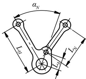
Рис. 2.4.3-2 Прицепной шатун
