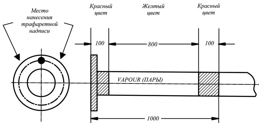
Рис. 6.1.12 Маркировка шланга сдачи паров груза
