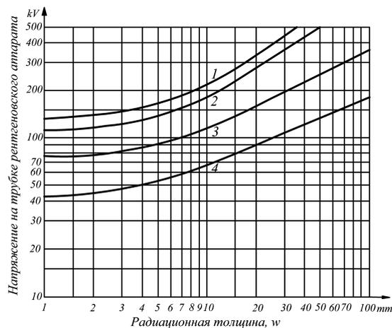
Рис. 3.2.5.5 Максимальные значения напряжения на трубке рентгеновского аппарата зависимости от радиационной толщины контролируемого металла:
