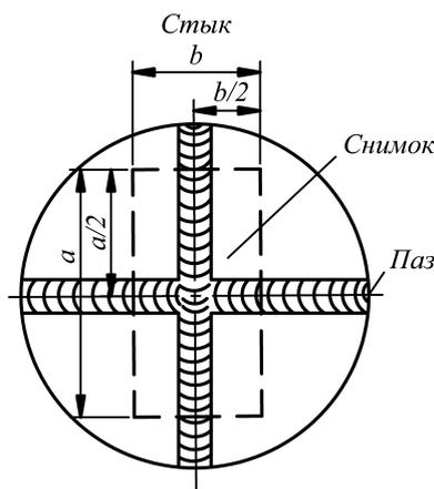
Рис. 3.2.1.11-1:  $a$  – длина снимка, равная ~ 500 мм;  $b$  – ширина снимка, равная ~100 мм
