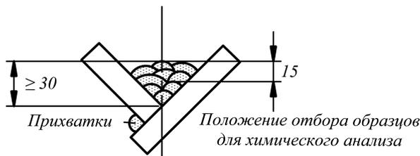
Рис. 4.10.2 Проба для испытаний наплавленного металла
