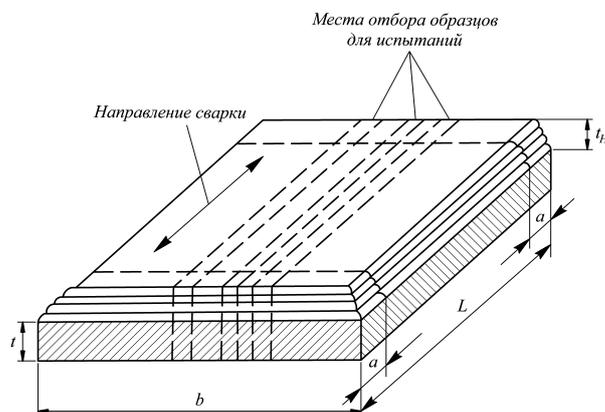
Рис. 4.8.3.5.2 Проба-имитатор лакирующей наплавки:
