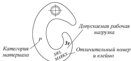
Рис. 11.2.1-1 Маркировка гака
