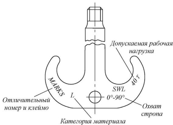
Рис. 11.2.1-2 Маркировка двуругого гака
