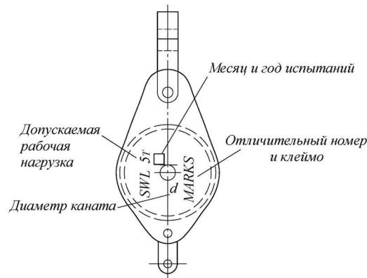
Рис. 11.2.1-5 Маркировка блока
