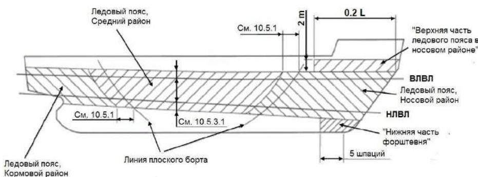
Рис. 10.5.1.1 Районы ледовых усилий корпуса судна
