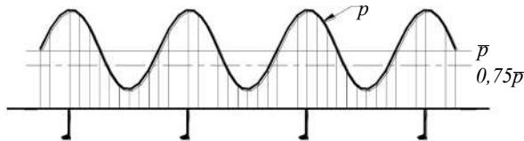
Рис. 10.5.1-1 Распределение ледовой нагрузки по борту судна
