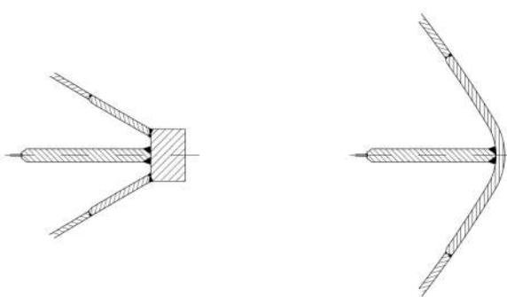
Рис. 10.5.7.1 Примеры допустимой конструкции форштевня
