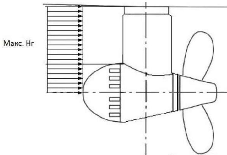
Рис. 10.7.6.5.3 Определение зоны контакта при преодолении тороса
