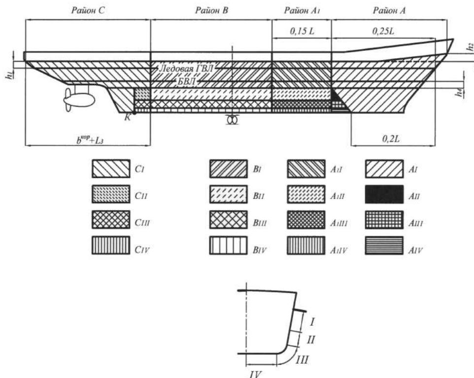
Рис. 19.2.2.3 Районы ледовых усилений арктических судов двойного действия, имеющих в символе класса знак ледового класса **Icebreaker6** или **Icebreaker7** при движении кормой вперед:
