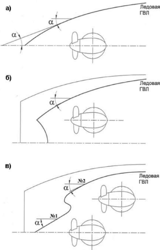
Рис. 19.2.4.1 Определение углов наклона ватерлинии в кормовой оконечности:
