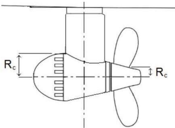
Рис. 10.7.6.5.2 Определение  $R_c$
