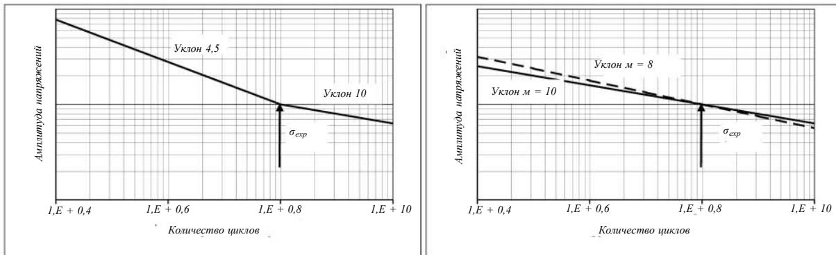
Рис. 10.7.6.2.3-1 Кривая усталости с двумя уклонами
