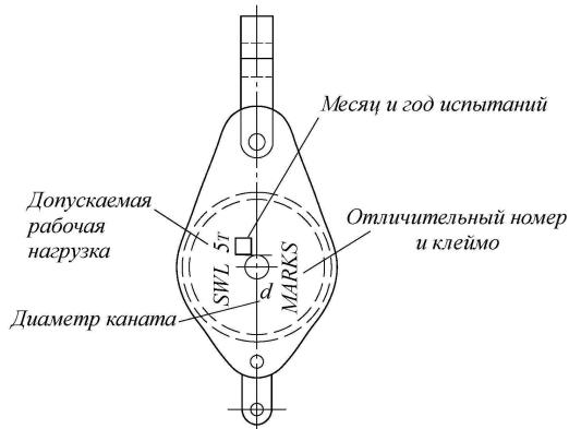
Рис. 11.2.1-5 Маркировка блока
