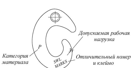
Рис. 11.2.1-1 Маркировка гака
