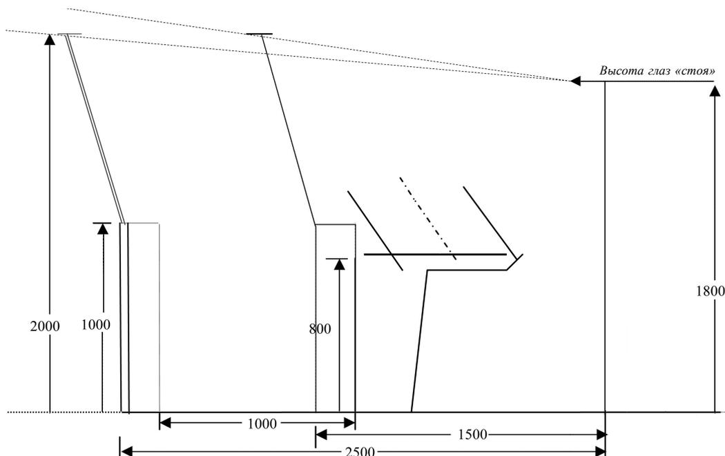
Рис. 2.6.3 При наклоне передних окон на угол  $15^\circ$  от вертикали угол обзора  $5^\circ$  выше горизонтали от уровня глаз стоящего человека, находящегося на высоте 1750 мм, может быть обеспечен на расстоянии 2600 мм от фронтальной стенки (лобовой переборки) с учетом наличия прохода шириной 1000 мм перед пультами рабочего поста
