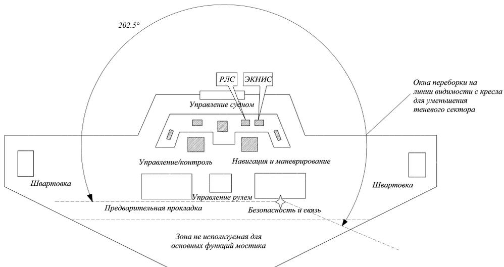
Рис. 2.5.17-2 Требуемая зона видимости с поста радиосвязи, во время контроля и эпизодического кратковременного использования оборудования ГМССБ вахтенным помощником.
