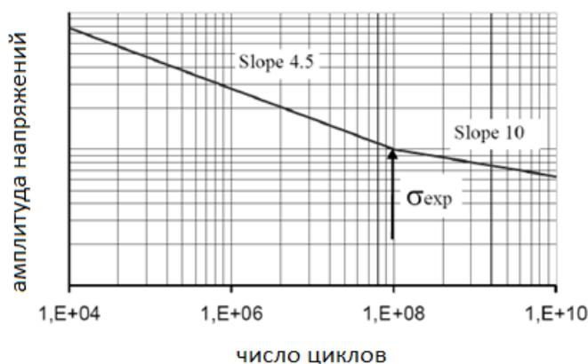
Рис.3.3.3.3-1. Кривая усталости с двумя уклонами
