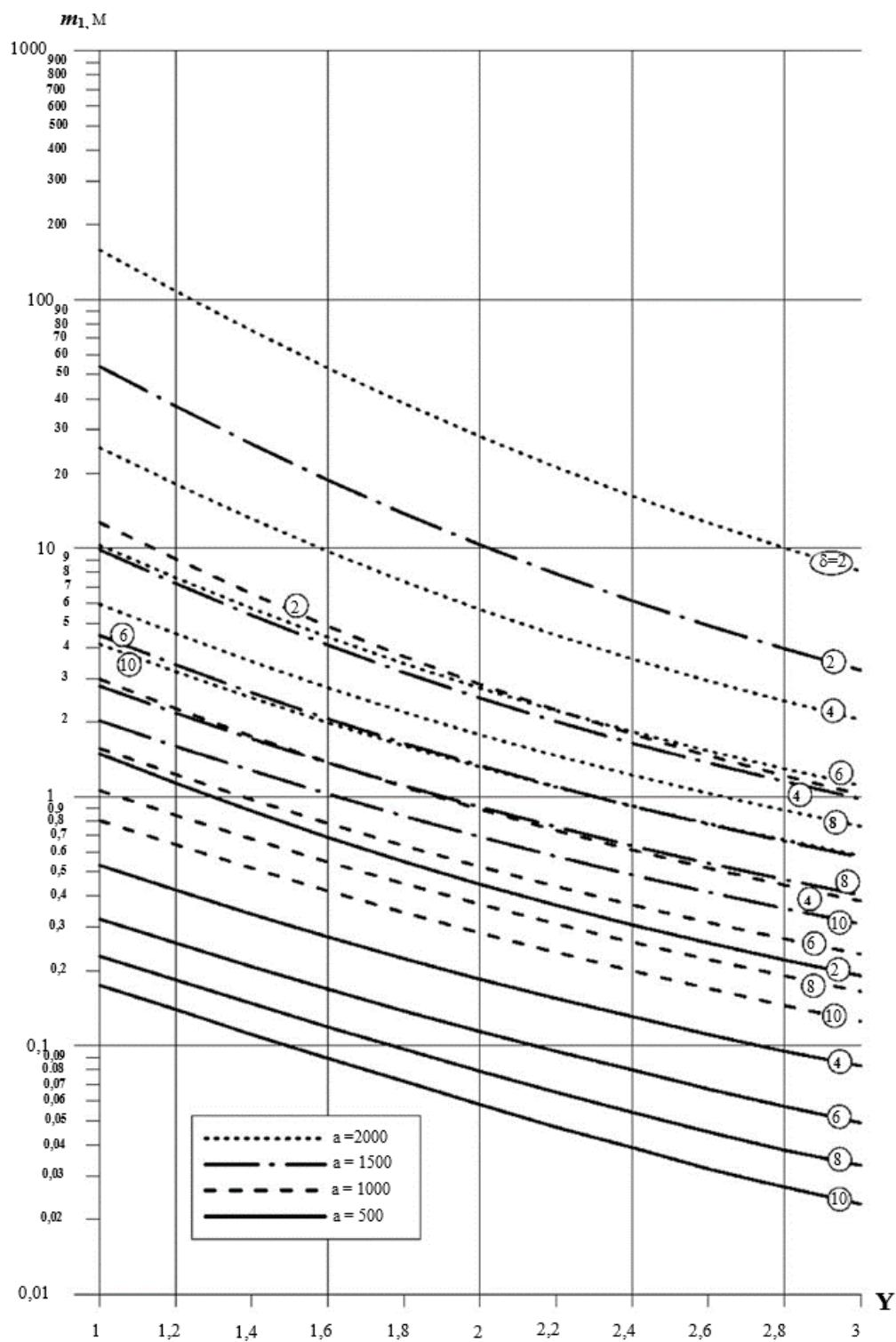
В кружках обозначены значения толщины  $\delta$ , мм, несущего слоя трехслойной пластины
