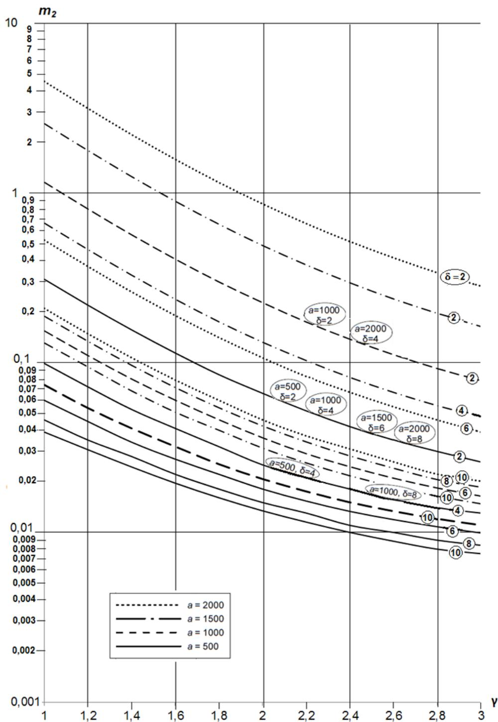
В кружках обозначены значения толщины  $\delta$ , мм, несущего слоя трехслойной пластины.
