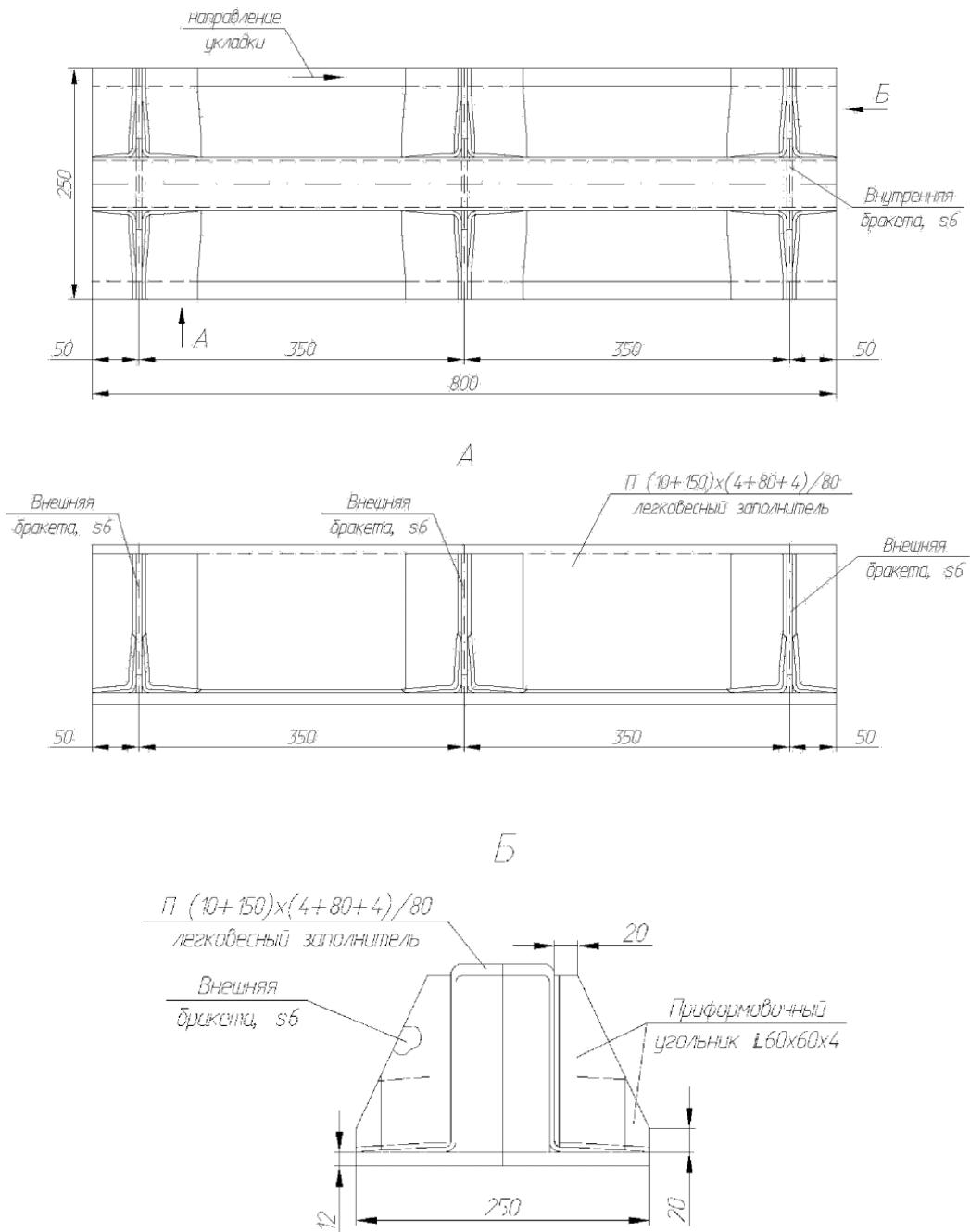
10 — толщина свободного пояска, мм; 150 — высота сердечника из легковесного заполнителя, мм;
