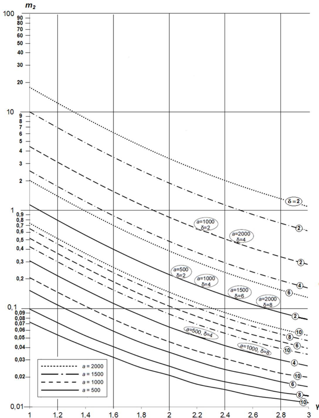
В кружках обозначены значения толщины  $\delta$ , мм, несущего слоя трехслойной пластины.
