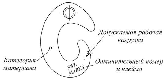
Рис. 11.2.1-1 Маркировка гака
