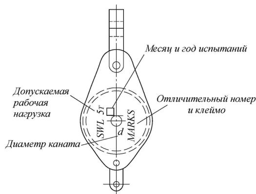
Рис. 11.2.1-5 Маркировка блока
