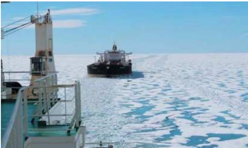
Рис. 2 Проводка танкера «Пропонтис» атомным ледоколом типа «Таймыр» [13]
