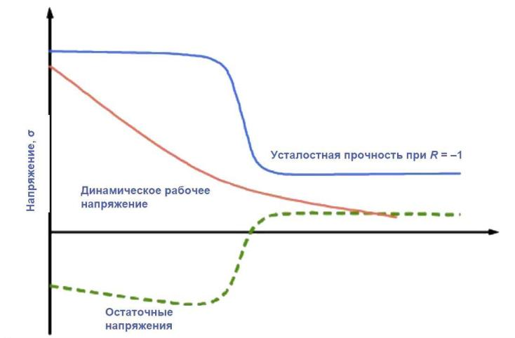
Рис. 3. Общие принципы зависимости напряжений от глубины
