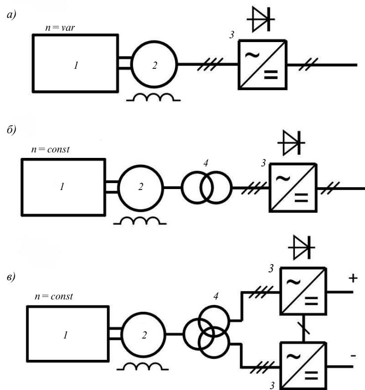
Рис. 3.1-2 Структурные схемы вентильных генераторов на базе неуправляемых выпрямителей:
