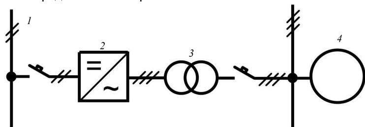
Рис. 3.3.1-4 Схема подключения эквивалентного электродвигателя в ЭЭС с полным распределением электроэнергии на постоянном:
