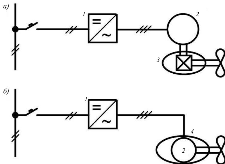
Рис. 3.2-4 Структурные схемы ГЭУ с винторулевыми колонками:
