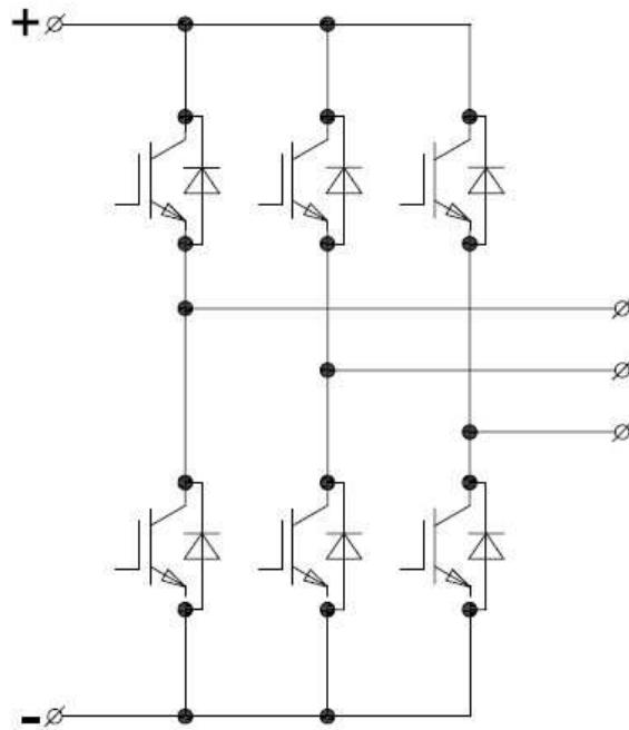
Рис. 3.2-1 Автономный инвертор
