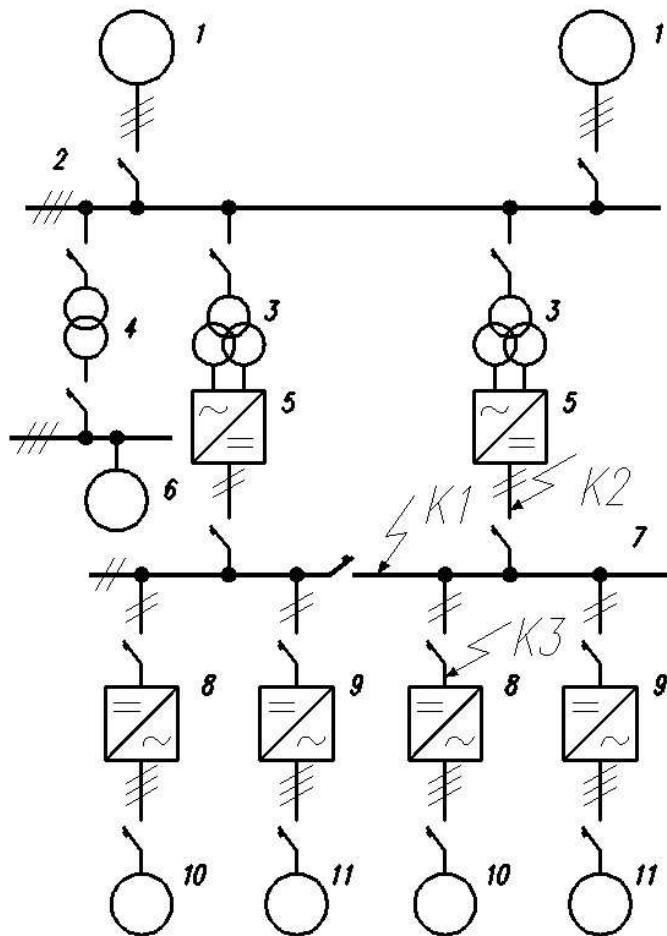
Рис. 6.2 Точки к.з. в ЭЭС с частичным распределением вырабатываемой электроэнергии на постоянном токе:
