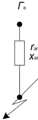
Рис. 8.2.1-4 Эквивалентная схема замещения последовательно соединенных участков
