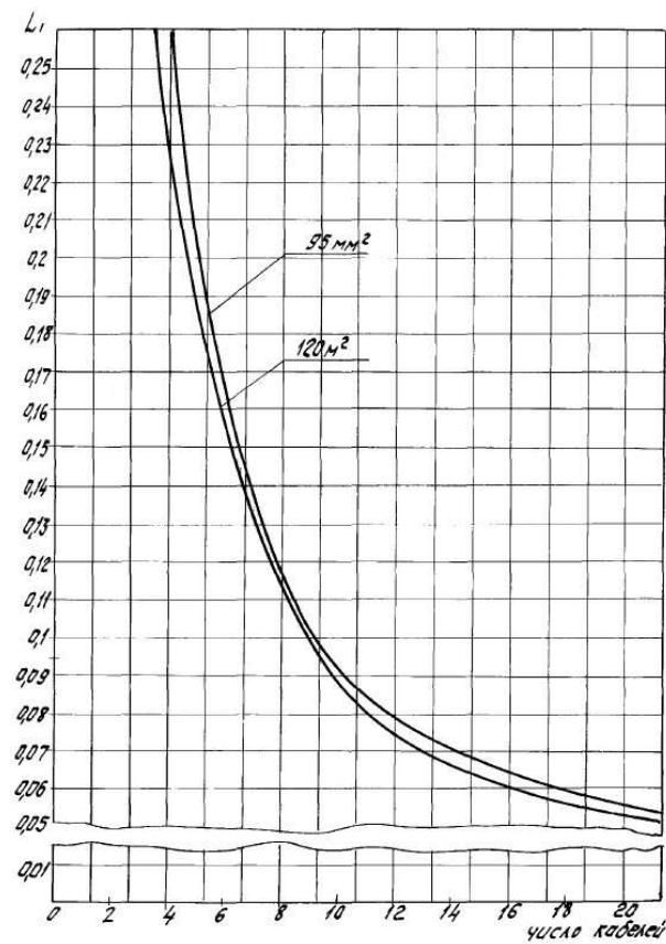
Рис. 8.6-4 Кривые для определения удельной индуктивности кабельной трассы в зависимости от числа кабелей и сечения токопроводящей жилы кабеля марок КВД-60, КВД-100 и КРНГ-60, Г/м •  $10^{-6}$
