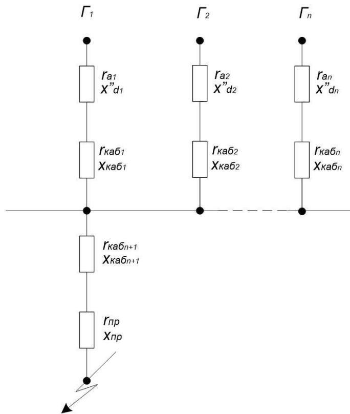
Рис. 8.2.1-1 Схема замещения для расчетов тока к.з. генераторов в ЭЭС с частичным распределением электроэнергии на постоянном токе:
