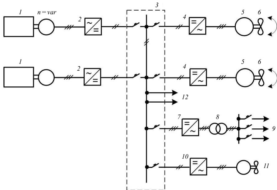
Рис. 2.2-1 Структурная схема ЭЭС с полным распределением вырабатываемой электроэнергии на постоянном токе и системой электродвижения с прямой передачей вращающего момента на винт:
