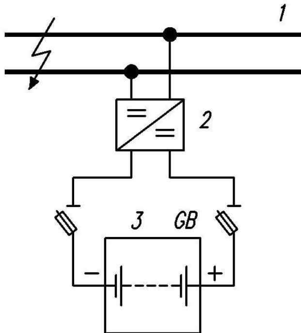
Рис. 3.5-2 Схема подключения аккумуляторных батарей в сети постоянного тока ЭЭС
