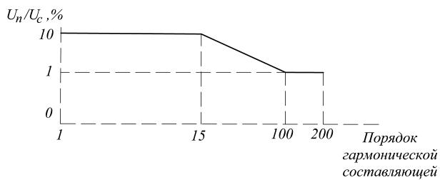
Рис. 2.2.1.2.2 График высших гармонических составляющих судовой сети
