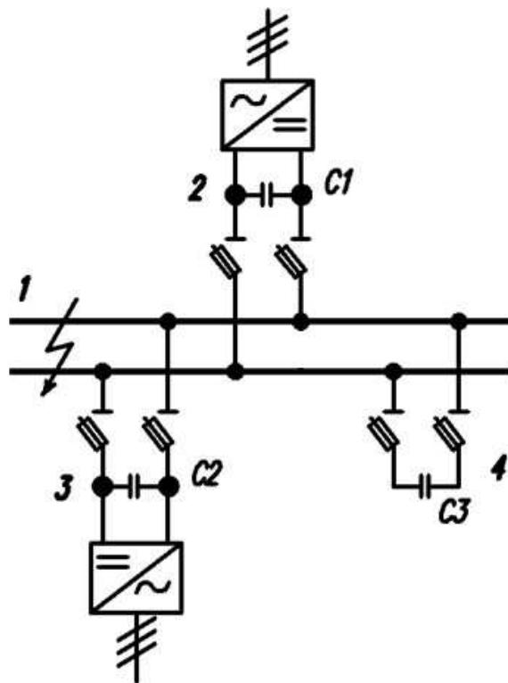
Рис. 3.4 Схема подключения конденсаторных батарей в сети постоянного тока ЭЭС:
