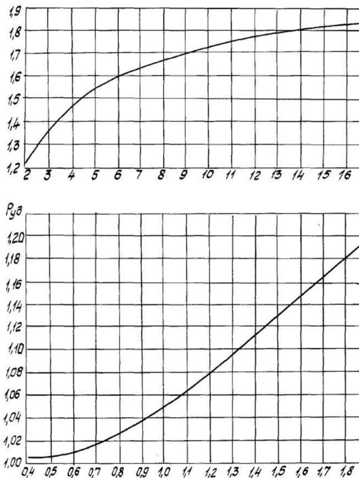
Рис. 8.2.1-6 Зависимость ударного коэффициента  $P_{y\partial}$  от отношения  $x/r$  цепи к.з.:
