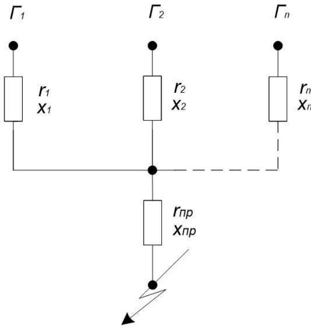
Рис. 8.2.1-2 Расчетная схема замещения отдельного участка
