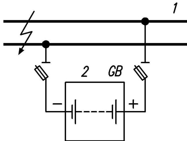
Рис. 3.5-1 Схема подключения аккумуляторных батарей в сети постоянного тока ЭЭС:
