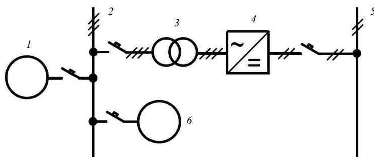
Рис. 3.3.1-2 Схема подключения эквивалентного электродвигателя в ЭЭС с частичным распределением электроэнергии на постоянном токе:
