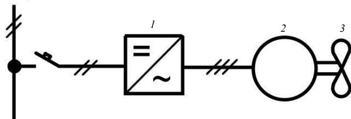
Рис. 3.2-2 Структурная схема ГЭУ с прямой передачей вращающего момента на винт:
