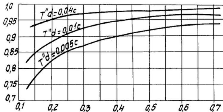
Рис. 8.2.1-5 Кривые зависимости коэффициента затухания периодической составляющей тока к.з. от  $Z_p^*$  и постоянной времени периодической составляющей сверхпереходного тока к.з.  $T_d''$ , где по оси абсцисс указаны значения расчетного сопротивления до точки к.з.  $Z_p^*$ , а по оси ординат – значения коэффициента затухания  $\gamma$
