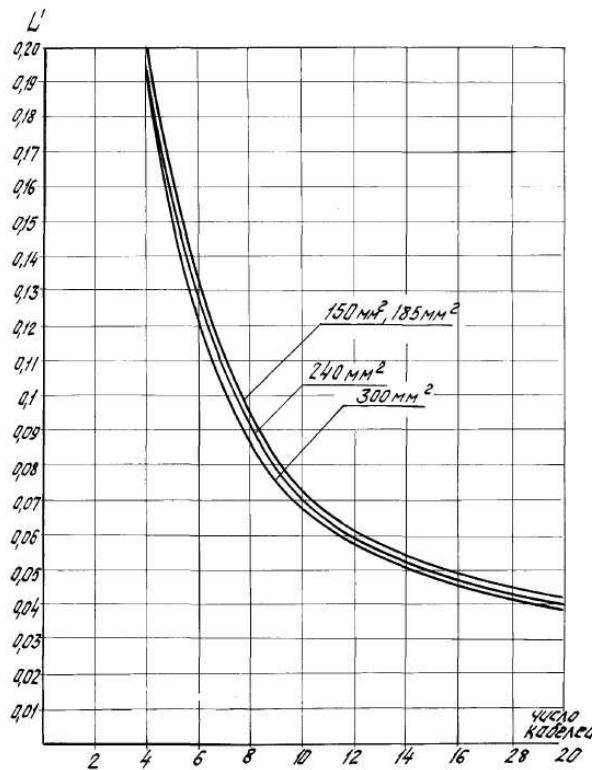
Рис. 8.6-3 Кривые для определения удельной индуктивности кабельной трассы в зависимости от числа кабелей и сечения токопроводящей жилы кабеля марки НРШМ, Г/м  $\cdot 10^{-6}$
