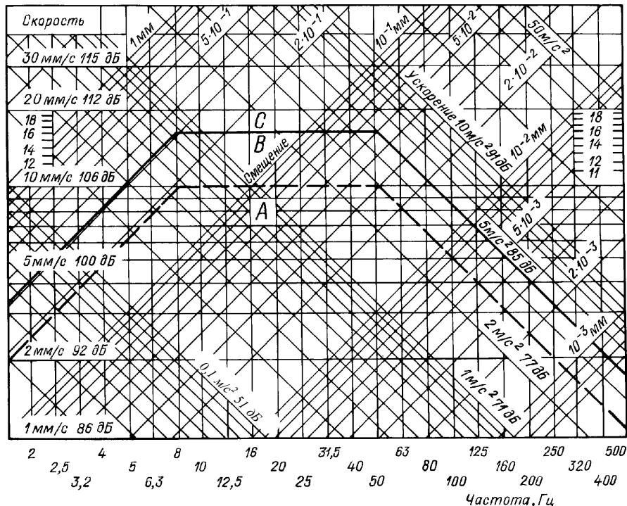
Рис. 9.6.1 Нормы вибрации поршневых компрессоров:
