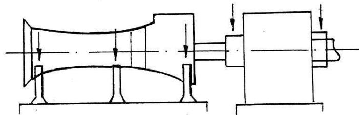
Рис. 9.8.1-2 Точки измерения вибрации
