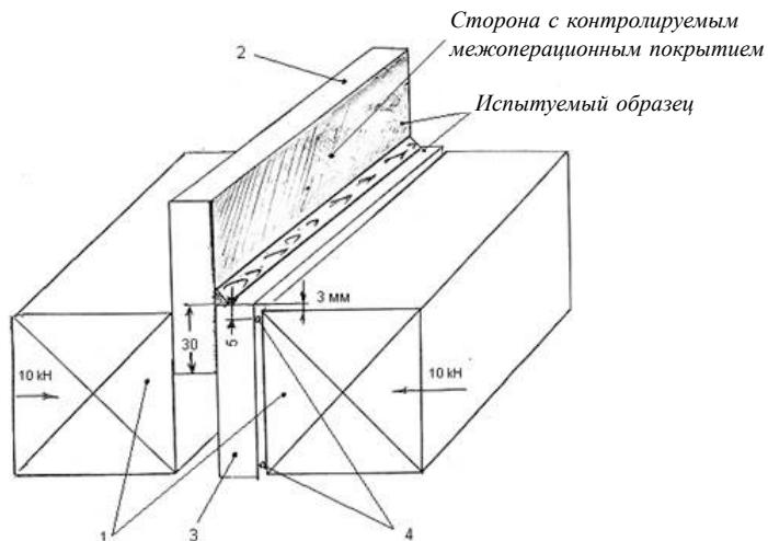
Рис. 2.6.2.1 Стандартный образец на порообразование с контролльным сварным швом:
