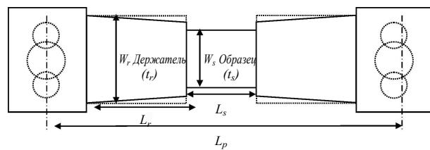
Рис. 3.20.6.2 Схема расположения испытываемого образца, держателя и оснастки
