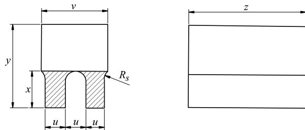
Рис. 3.9.5.1-2 Стандартный образец с размерами:  $u = 25$ ;  $v = 90$ ;  $x = 40$ ;  $y = 100$ ;
