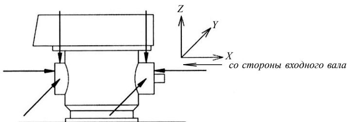
Рис. 9.9.2 Точки измерения вибрации винторулевых колонок
