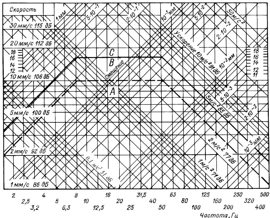
Рис. 9.6.1 Нормы вибрации поршневых компрессоров:
