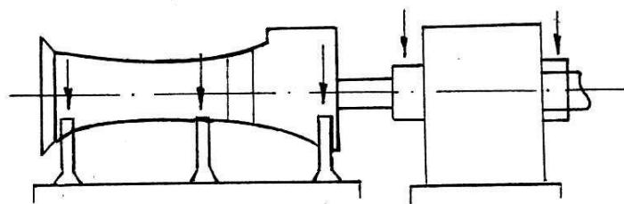
Рис. 9.8.1-2 Точки измерения вибрации
