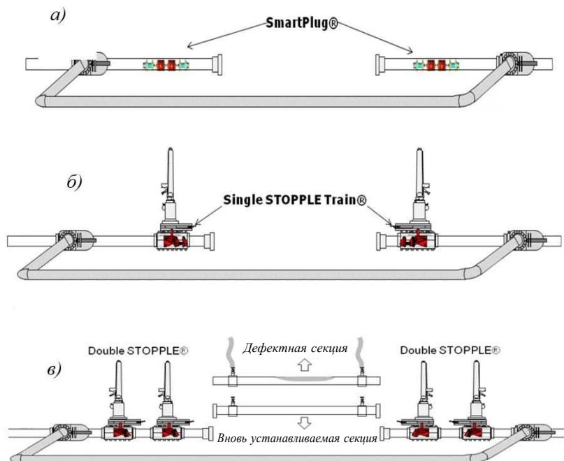
Рис. 12.3-5 Сооружение байпасной линии с использованием запорных устройств SmartPlug (а), технологии врезки Hot Tapping с применением устройств Single STOPPLE Train (б) и Double STOPPLE Train (с)
