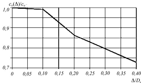
Рис. 7 Зависимость  $c_v(\Delta)/c_v$  от относительного заглубления трубопровода  $\Delta/D_a$
