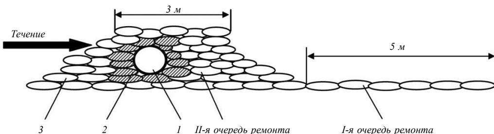
Рис. 12.1-1 Схема ремонта оголенных участков МПТ с применением мешков с песчано-цементной смесью:
