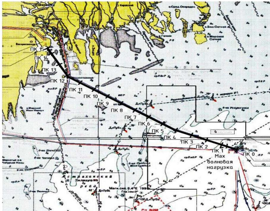
Рис. 1.2 План трассы проектируемого морского подводного трубопровода
