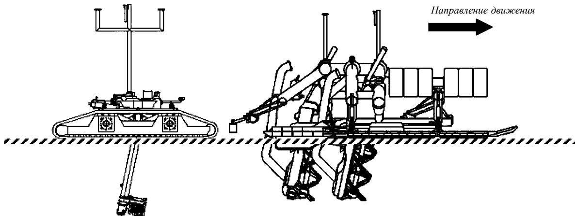
Рис. 7.6-2 Устройство заглубления подводного трубопровода компании Saipem S.p.A.
