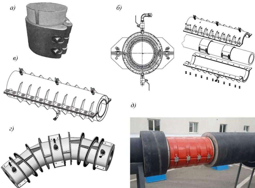
Рис. 12.3-2 Устройства для ремонта подводных трубопроводов, одобренные РС
