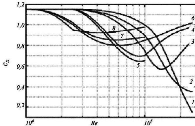
Рис. 4.3.1-3 График коэффициента  $c_x$  от числа Рейнольдса и относительной шероховатости поверхности трубы  $k$ :
