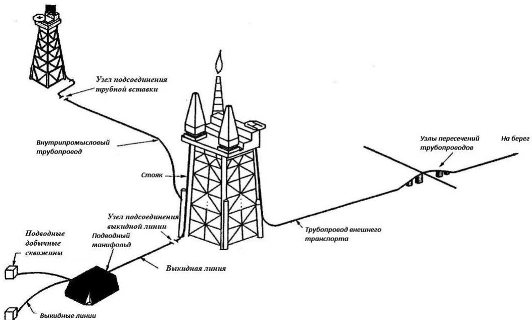
Рис. 2.1-2 Трубопроводы в составе объектов обустройства подводного месторождения углеводородов [12]
