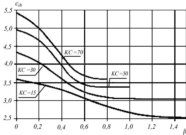
Рис. 9-2 Коэффициент  $c_{ib}$  в зависимости от коэффициента  $\beta$
