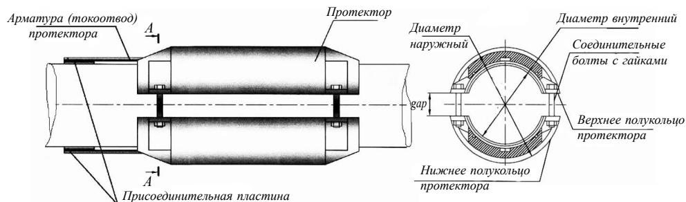
Рис. 8.4-2 Схема установки протектора на необетонированный трубопровод
