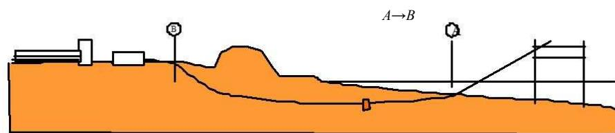
2. ННБ с буровой установкой, установленной на морской буровой платформе
