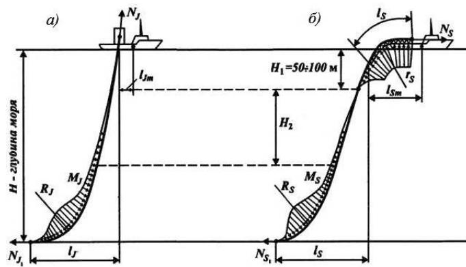
Рис. 7.1-3 Эпюры изгибающих моментов при укладке различными способами [1]:
