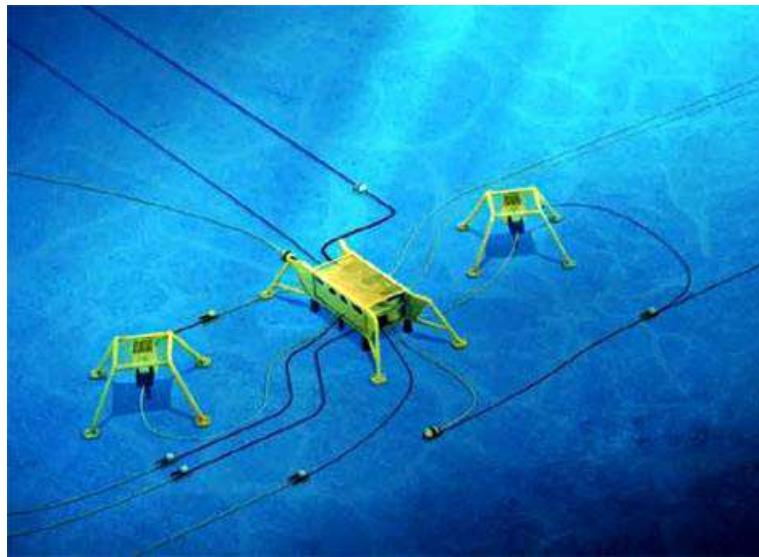
Рис. 3.1 Подводный добывающий комплекс (ПДК) и подводные трубопроводы (МПТ): манифольд, добывчные скважины с подводным расположением устья с защитными конструкциями и подводные трубопроводы [2]
