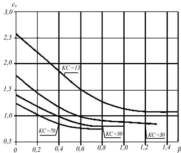
Рис. 9-3 Коэффициент  $c_v$  в зависимости от коэффициента  $\beta$
