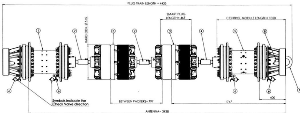
Рис. 12.3-4 Общий вид и компоновка затвора  $2 \times 24"$  типа SmartPlug:
