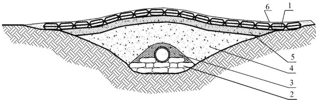
Рис. 12.1-2 Схема ремонта размыва с использованием гибких бетонных матов:
