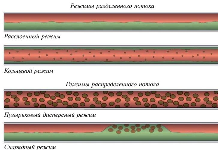
Рис. 2.5.4-1 Основные гидродинамические режимы двухфазного газожидкостного потока [14]
