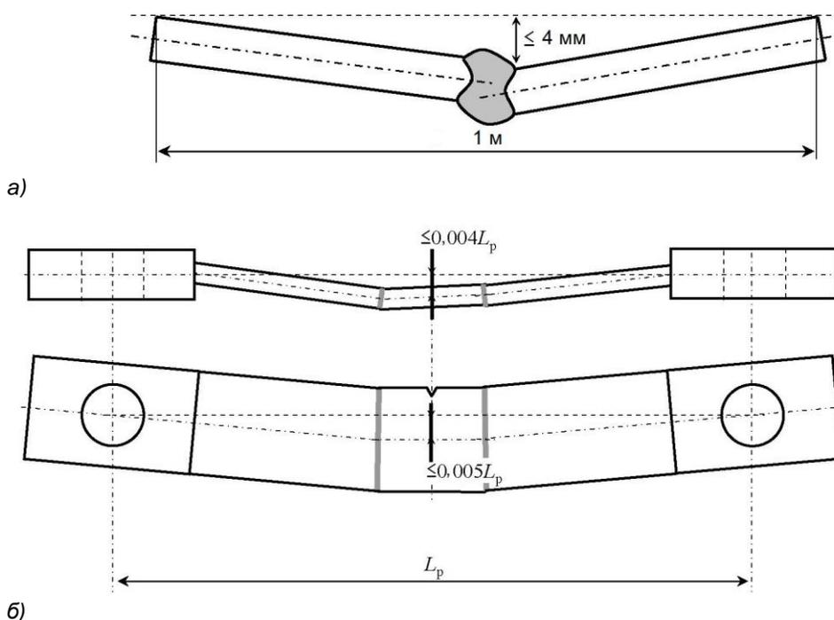
Рис. 2.2.11.1.4.3 Допуски отклонения формы сварных соединений образцов:
