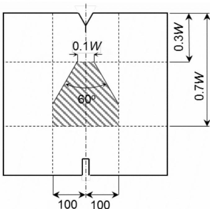
Рис. 2.2.11.4.6.2.2 Область допустимой траектории распространения магистральной трещины
