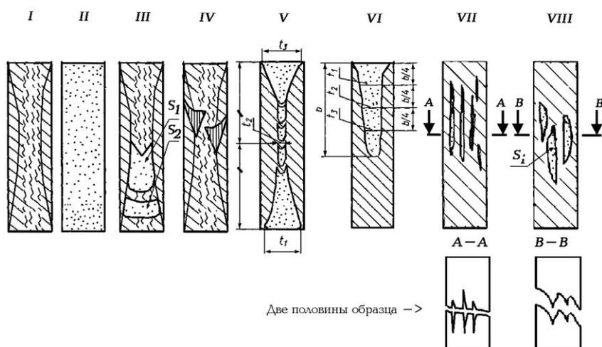
Рис. 2.2.10.2.4.1 Типы разрушения в пределах зачетной площади
