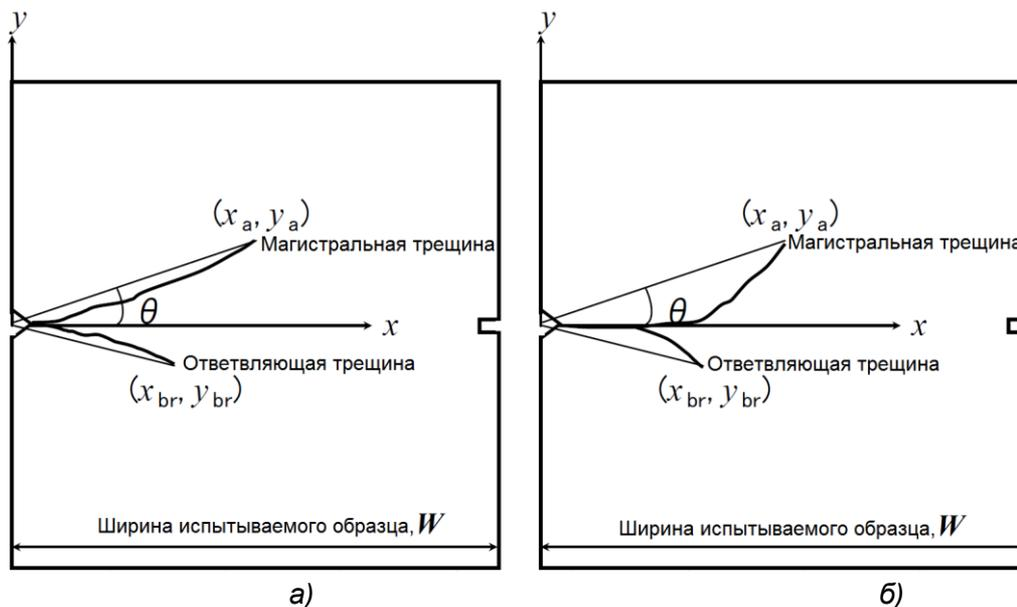
Рис. 2.2.11.1.6.4.2.2 Измерение длин магистральной и ответвляющейся трещин:
