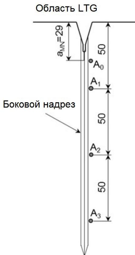
Рис. 2.2.11.4.5.2.4.1 Изображение области LTG и расположение дополнительной термопары  $A_0$
