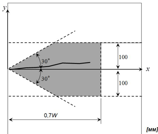
Рис. 2.2.11.1.7.1.1 Допустимые пределы траектории распространения магистральной трещины
