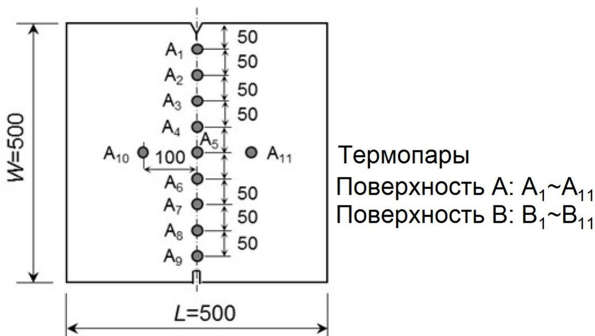
Рис. 2.2.11.4.5.2.2 Расположение термодпар при измерении температуры
