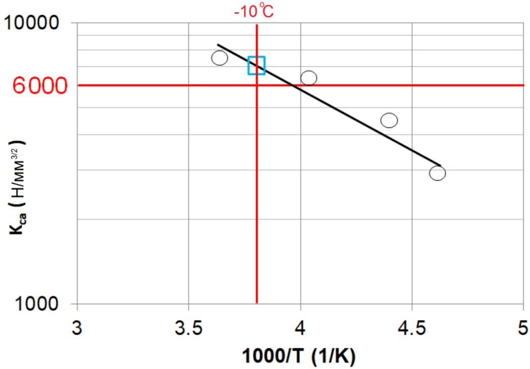
Рис. 2.2.11.2.3.1 Пример оценки  $K_{ca}$  при температуре  $-10^\circ\text{C}$
