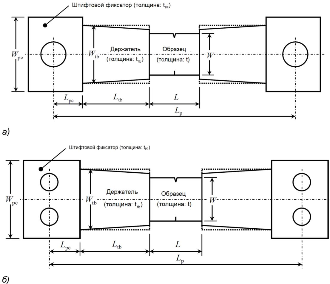
Рис. 2.2.11.1.4.2-1 Определения размеров держателей и штифтовых фиксаторов:
