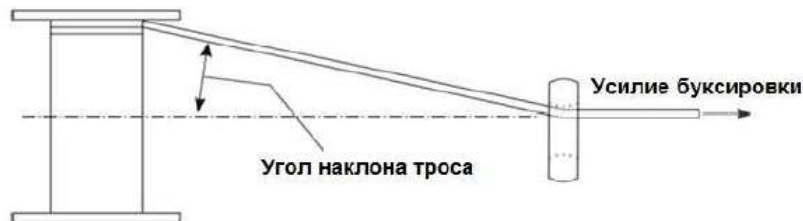
Рис. 6.6.1-2 Угол наклона троса по отношению к барабану лебедки
