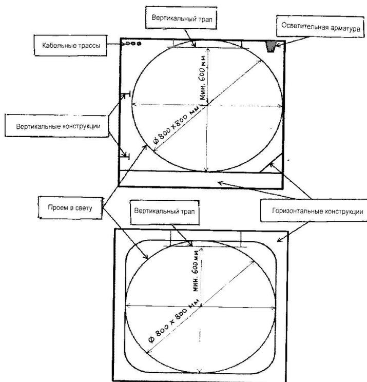
Рис.4.5.5 Пример возможного исполнения выхода через люк с учетом минимальных внутренних размеров в свету
